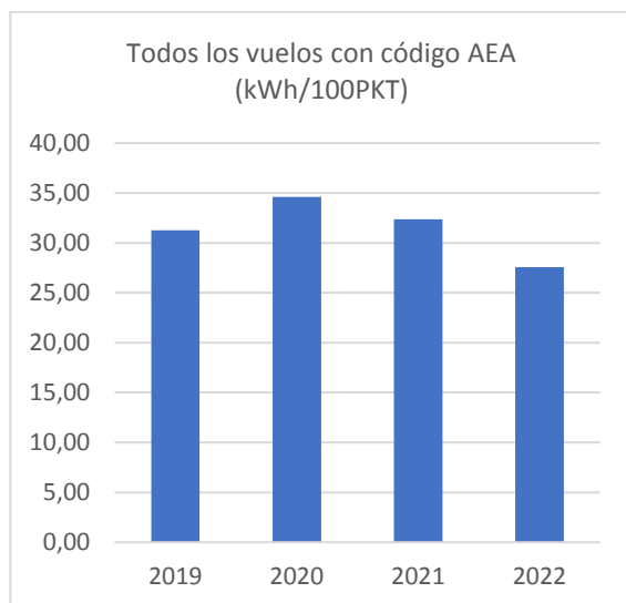
Gráfica 7. Evolución del consumo de combustible (kWh/100Pasajeros por Kilómetro Transportado) de todos los vuelos operados
